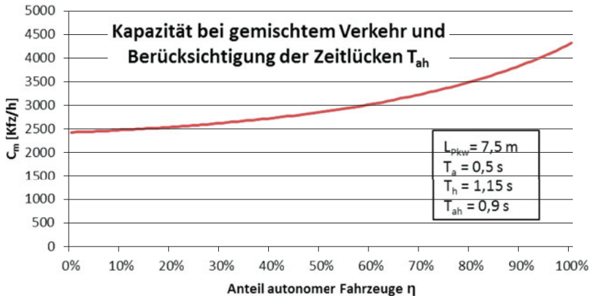
Abb. 16.10 Kapazität eines Fahrstreifens in Abhängigkeit des Anteils autonomer Fahrzeuge bei reinem Pkw-Verkehr unter Berücksichtigung größerer Folgezeitlücke von autonomen Fahrzeugen auf von Fahrern gelenkte Fahrzeuge
